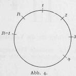
sieben) Zylinder sind radial, in zwei Gruppen angeordnet, die eine zu vier, die andere zu drei Zylindern, je an einer Kurbel angreifend. Der Grundgedanke ist folgender: Denken wir uns eine ungerade Anzahl im Viertakte arbeitender Zylinder auf einem Kreise angeordnet (Abb. 4) und lassen wir die Verpuffungen in der Reihenfolge vor sich gehen:
