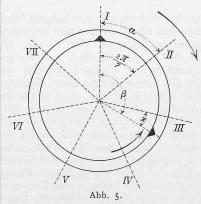
also ein Nocken gegenüber Zylinder III stehen muss. Da Zylinder II zur Zeit noch nicht zünden darf, so sind wir gezwungen, einen neuen Nocken für III hinzustellen, er bilde zur Zeit o den 孝 x mit Zylinder III. Nach zwei vollen Umdrehungen der Kurbelwelle muss dieser Nokken vor Zylinder I zustehen kommen, d. h. er muss, nachdem die Kurbelwelle
