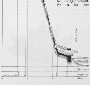
maximale Wasserführung von 20  $m^3/Sek$ , bestimmt, bei der die Wassergeschwindigkeit nicht ganz 2,5 m erreicht. Der Stollen hat bei 420 m Länge ein Gefälle von 4,25  $^0/_{00}$  und steht an seinem untern Ende an der Sohle unter etwa 9 m ruhendem Wasserdruck. Er durchfährt in gerader Rich-
