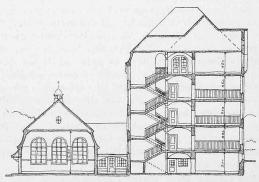
Querschnitt durch Schulgebäude und Turnhalle. Masstab I:500.
