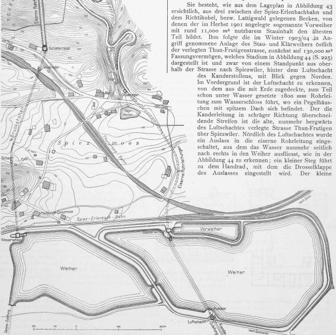
Abb. 43. Lageplan der Weiheranlage auf dem Spiezmoos mit der alten und der neuen Druckleitung zum Turbinenhaus. — Masstab 1:4000.
