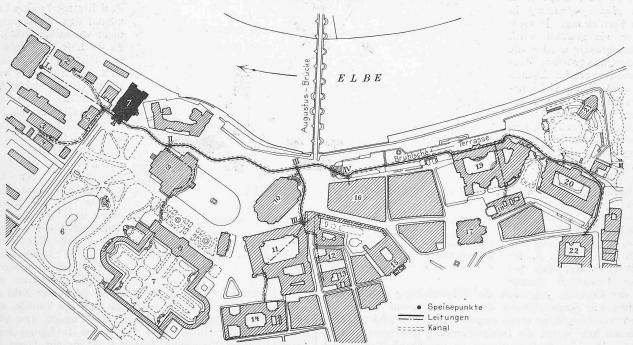
Abb. 8. Lageplan des Fernheizwerkes Dresden. — Masstab 1:6000.
