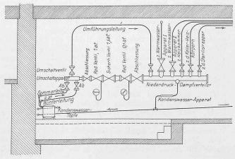
Abb. 11. Schematische Darstellung eines Regulierraums.
