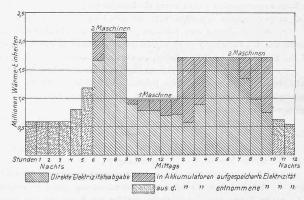
Abb. 2. Wärmebedarf für elektr. Krafterzeugung. Wintertag.
