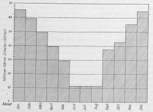
Abb. 7. Mittlerer stündl. Wärmebedarf der verschiedenen Monate.
