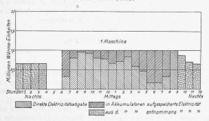
Abb. 1. Wärmebedarf für elektr Krafterzeugung. Sommertag.
