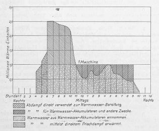
Abb. 3. Wärmebedarf der Warmwasserversorgung. Sommertag.
