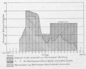
Abb. 4. Wärmebedarf der Warmwasserversorgung. Wintertag.
