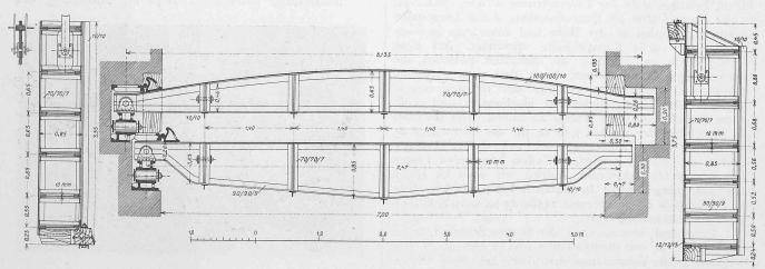
Abb. 26. Horizontalschnitt und Vertikalschnitte durch die beiden Grundablass-Schützen. -- Masstab 1:60.
