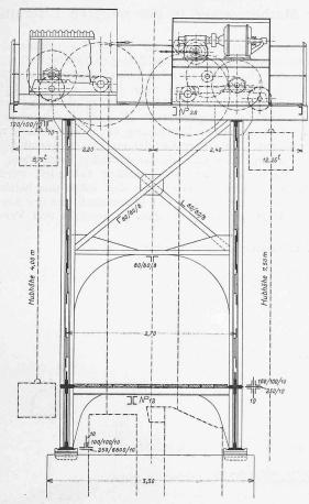
Abb. 25. Querschnitt durch das Turmgerüst. — 1:60.
