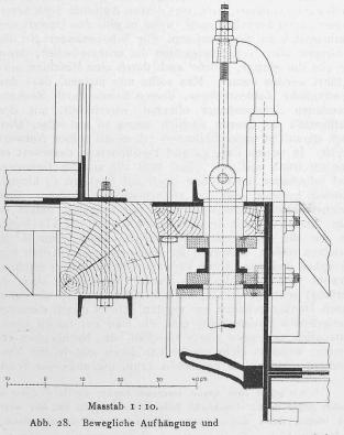
Abdichtung des Dichtungsstabes der untern Schütze. — Vertikalschnitt.
