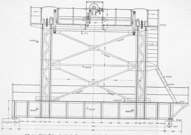
Abb. 24. Simme-Wehr. Ansicht des Turmgerüstes für den Grundablass-Schützen-Aufzug. - Masstab 1:60.
