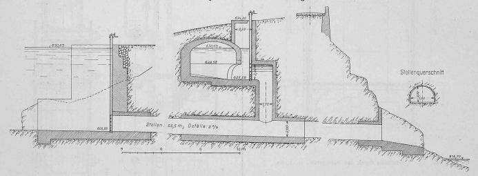
Abb. 30. Längsschnitt durch den provisorischen Stollen, Schnitt durch Zulaufstollen, Sandfang und Spühlschacht. — Masstab 1:300.
