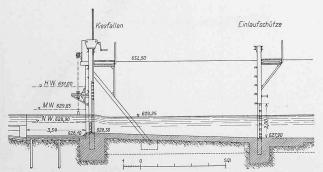
Abb. 7. Längsschnitt durch den Kanaleinlauf. — Masstab 1: 200.
