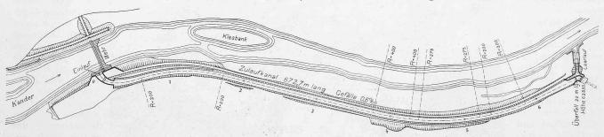
Abb. 4. Lageplan des Zulaufkanals mit Wehr, Ueberfall und Stolleneinlauf. — Masstab I: 4000.
