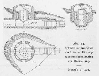
panzerturmähnliche *Luft- und Einsteigschacht*, dessen Abmessungen der Abbildung 13 zu entnehmen sind. Er hat einen innern Durchmesser von 2,10 m, der lichten Breite des Stollens entsprechend, ist oben offen und samt der ringförmigen Ueberlaufschale von einem flachen Betongewölbe überdeckt. Acht seitliche Oeffnungen ermöglichen den Ein- und Austritt der Luft bezw. des bei Druckstössen etwa überfliessenden Wassers. Von hier führt eine 224,34 m lange eiserne Rohrleitung von 1,80 m Weite und 5 mm
