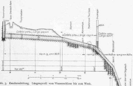
Abb. 3. Kanderzuleitung. Längenprofil vom Wasserschloss bis zum Werk. Masstab für die Längen 1:4000, für die Höhen 1:400.
