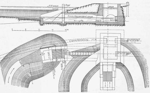
Abb. 14. Längsschnitt und Grundriss durch das Wasserschloss der Kanderleitung. — Masstab 1:400.
