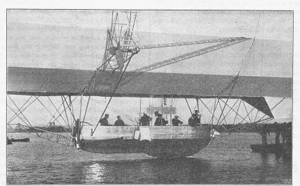
Abb. 3. Vordere Gondel des Zeppelinschen Luftschiffes Nr. IV.
