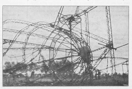
Abb. 2. Ansicht des Hinterteils mit dem Gerippe des Seitensteuers.
