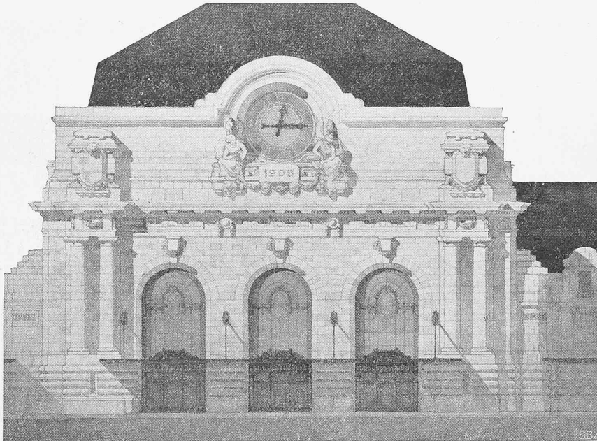
Geometrische Ansicht der Mittelpartie der Hauptfassade. — Masstab 1 : 400.
