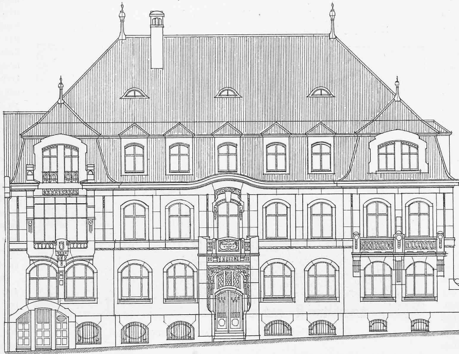
Abb. 7. Geometrische Ansicht der Fassade am Petersgraben. — Massstab 1:200.
