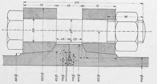
Abb. 24. Flanschenverbindung der Druckleitung. — 1:4.
