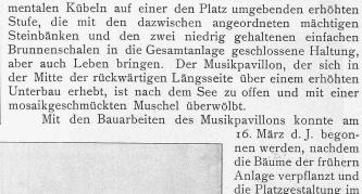
die Bäume der frühern Anlage verpflanzt und die Platzgestaltung im Rohen vorbereitet worden war. Der ganze Bau ruht auf einer armierten Betonplatte; auch die Umfassungswände bis zur Höhe des Podiums, die beiden Pylonen die teilweise armierte Kuppelkonstruktion sind aus Beton hergestellt worden. Die Muschel besteht aus einem doppelten Gewölbe mit einem Hohlraum von 0,60 m zwischen beiden Kappen. Das
