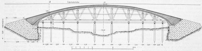
Abb. 26. Längsschnitt durch die Galfingerbrücke mit Lehrgerüst. — Masstab 1:250.
