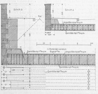
Abb. 27. Querschnitte a und b und Armierungsplan. — 1:75.
