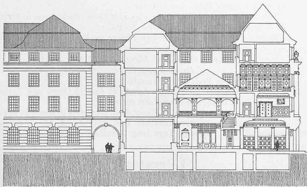
Längsschnitt durch das Gebäude der Schw. Nationalbank. 1 : 600.
