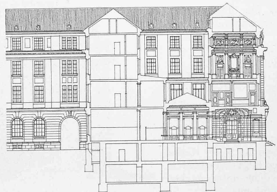
Längsschnitt durch das Gebäude der Schw. Nationalbank. 1 : 600.
