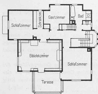
Abb. 8. Grundriss vom Obergeschoss des Hauses Hesse. — 1:400.
