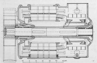
Abb. 57 und 58. Schnitte und Seitenansicht des 225 PS-Motors der Lokomotive Nr. 3 Masstab 1:15.
