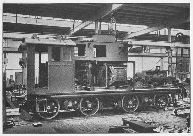
Abb. 61. Lokomotive Nr. 1 als Wechselstrom-Lokomotive, im Umbau.
