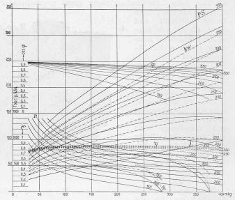
Abb. 60. Motorkurven der Lokomotive Nr. 3.
