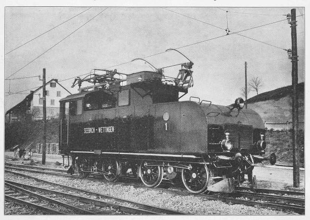
Abb. 63. Lokomotive Nr. 1 als Wechselstromlokomotive.
