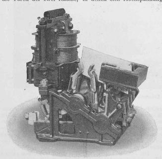
Abb. 55. Einzelschalter der Lokomotive Nr. 3.
