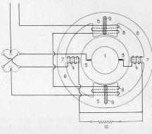
Abb. 49. Schema des 250 PS-Seriemotors.
