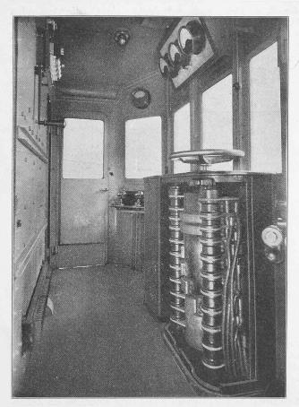
Abb. 48. Führerstand der Lokomotive Nr. 2.
