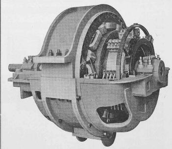
Abb. 51. Ansicht des 250 PS-Seriemotors.
