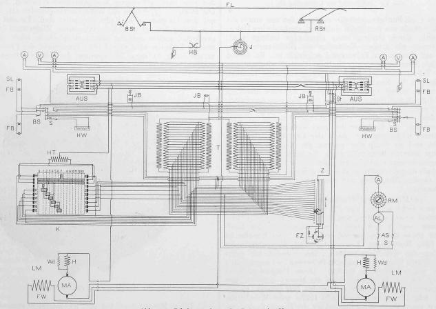
Abb. 47. Schaltungsschema der Lokomotive Nr. 2.
