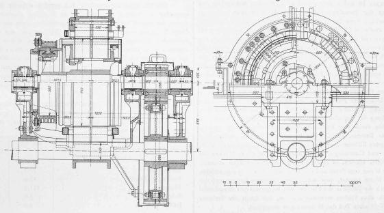
Abb. 50. Schnitt und Ansicht des 250 PS-Seriemotors der Lokomotiven Nr. 1 und Nr. 2. - Masstab I: 20.
