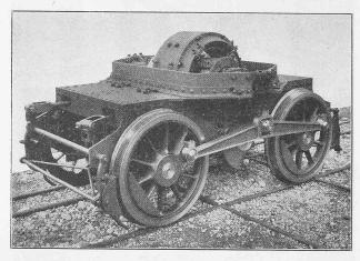
Abb. 46. Drehgestell der Lokomotiven Nr. 1 und 2.
