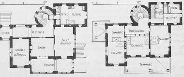
Fig. 1 et 2. Plans du rez-de chaussée et du premier étage de la villa Diserens au Signal. — Echelle 1:400.
