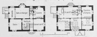
Fig. 14 et 15. Plans du rez-de-chaussée et du premier étage de la villa Jäger à Lausanne. — Echelle 1:400.
