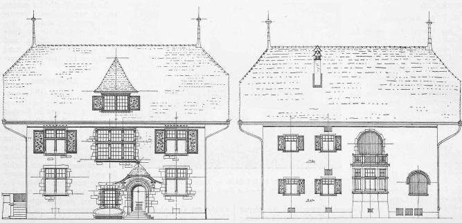
Fig. 11 et 12. Deux façades de la villa Jäger à Lausanne. — Echelle 1:200. — Architectes MM. Schmid et Rosset, Lausanne et Veytaux.
