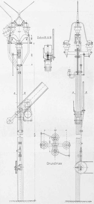
Abb. 21. Hörnerschalter mit Flügelsignal. — 1:25.
