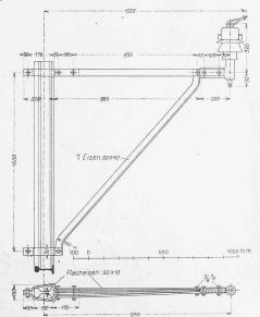
Abb. 19. Anordnung für seitliche Drahtbestreichung.
