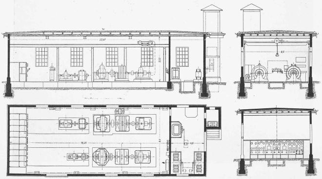
Abb. 5. Die Umformerstation. — Grundriss, Aufriss und Schnitte. — Masstab 1:200.
