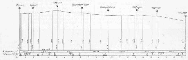
Abb. 2. Längenprofil der Linie Seebach-Wettingen.
