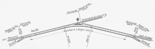
Abb. 3. Lageplan der Tunnelstation bei Seitenstollen II. - Masstab der Längen 1:5000.
