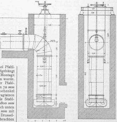
Abb. 7. Details zur Heberleitung. — Masstab 1:150.
