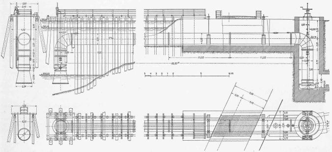
Abb. 6. Die Heberleitung - Ansicht, Grundriss und Schnitte. - Masstab 1:300.
