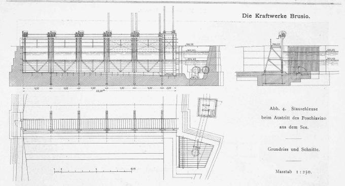
führte die Unternehmung D. Vitali & Cie. in Rom aus, und zwar wurden diese durch den Umstand erschwert, dass der reissende Strom im engen Taleinschnitt nicht abgeleitet werden konnte, sondern wechselweise eingeengt und trocken gelegt werden musste. Die Anordnung der Stauschleuse ist in Abbildung 4 dargestellt.
