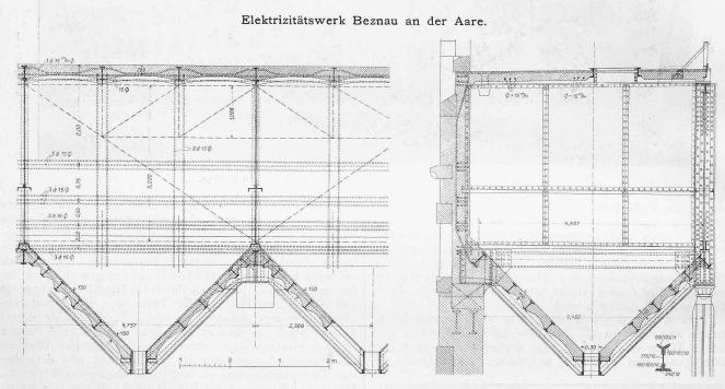
Abb, 21. Längenschnitt und Querschnitt eines Kohlenbunkers über dem Kesselhaus. — Masstab 1:75.
