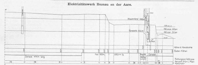
Abb. 13b. Längenprofil des Oberwasserkanals, nordöstliche Hälfte. — Masstab 1:4000 für die Längen, 1:400 für die Höhen.
