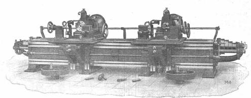
Doppelte Pleuelstangen-Bohr- und Fräsmaschine
