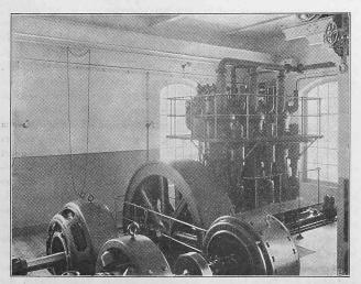
Abb. 3. Dreizylinder Dieselmotor von 300  $PS_e$ , n = 160, direkt gekuppelt mit einer Gleichstrom-Dynamo der Maschinenfabrik Oerlikon. (Elektr, Zentrale der Strassenbahn St. Gallen-Speicher-Trogen in Speicher.)
