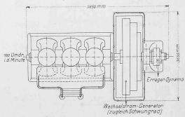
Abb. 1. Grundriss der 200 P. S. Dieselmotor-Dynamoanlage Silvaplana.
