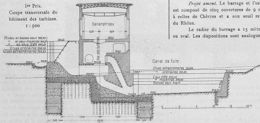
grilles de Chèvres. Le système spécial proposé pour leur nettoyage paraît peu pratique. La Commission estime que le bâtiment doit être dimensionné pour un écartement de 10 mètres d'axe en axe des grandes turbines et pour une largeur de 15 mètres au minimum pour la salle des machines.
