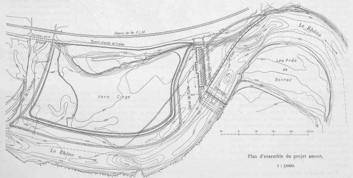
gesprochen, da der dadurch bedingte Verlust von 50 bis 80 cm Gefälle durch die Vorteile eines günstigeren Baugrundes und die Vermeidung der eventuellen Inanspruchnahme von Uferteilen des Nachbarstaates aufgewogen wird. Diesem Beschlusse zufolge wurden nur je die obern Projekte der Bewerber prämiert und beschränken auch wir uns in der Auswahl der wiederzugebenden Pläne auf diese.
