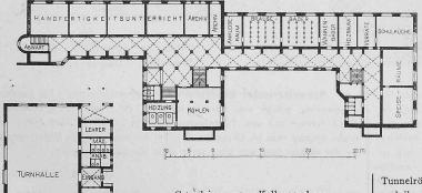
Grundrisse von Kellergeschoss, Erdgeschoss und Dachgeschoss des Schulgebäudes sowie vom Erdgeschoss der Turnhalle.
