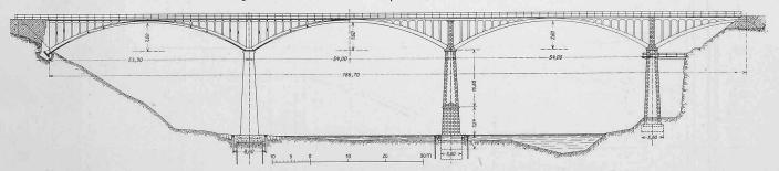
Fig. 2. Elévation et coupe longitudinale du pont de Pyrimont. Echelle 1:1000.
