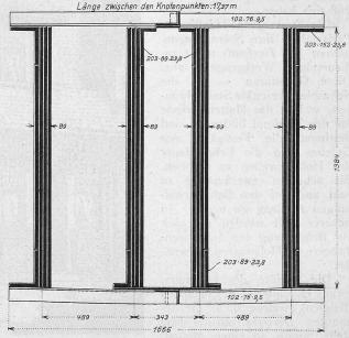
Abb. 2. Profil des Druckgliedes A 9 der Brücke. — Masstab 1:20.
