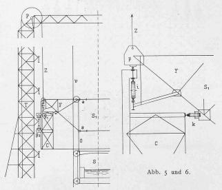
sich sein Gewicht gleichmässig auf die Gesamtzahl der radialen, mit einer Divergenz von etwa 10° angeordneten horizontalen Fachwerkträger F, aus denen sich das Traggestell  $S_1$  zusammensetzt, verteilt (siehe Abb. 7 und 6). Durch die früher erwähnten Führungsschienen v wird auch die vertikale Gradführung des Troggestelles bewirkt. Die Drahtseile Z sind dann an den äussern Enden der Tragbalken F befestigt, deren innere Enden durch einen ringförmigen Rahmen a (siehe Abb. 5 und 7) fest verbunden
