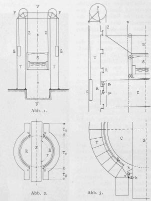
der Hängeseile Z, oder einer plötzlichen Entleerung des Troges. Da die sämtlichen beweglichen Teile der Trogschleuse im normalen Zustande stets durch Gegengewicht ausbalanciert sind, so rührt eine vertikale Beanspruchung des Geleises R nur von der Komponente jener Kraftäusserung her, die dazu dient, den Drehwagen in Bewegung zu setzen, bezw. zu erhalten.
