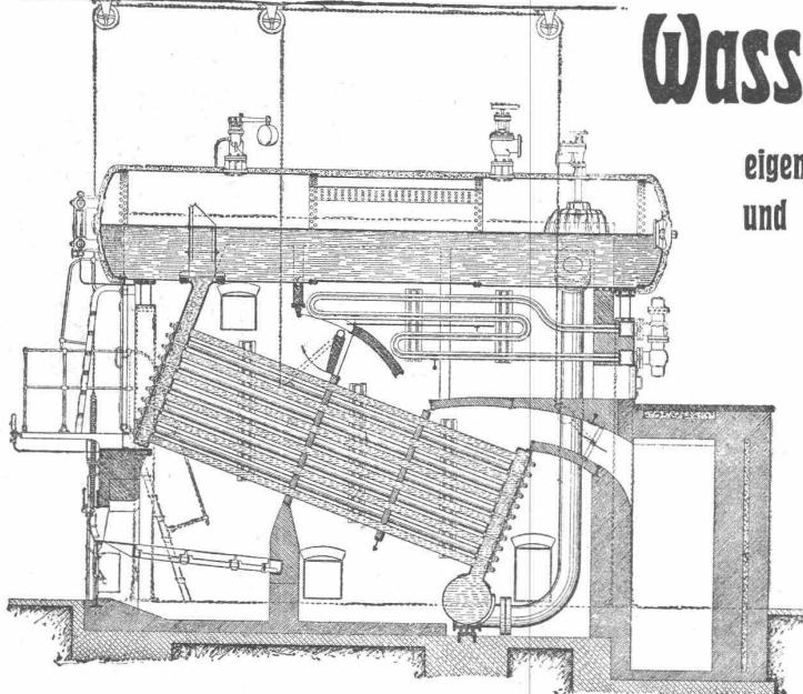
Kräftige Zirkulation und grosse Leistungsfähigkeit infolge direkter Wasserzuführung zu den unteren Rohrreihen.
