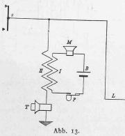
erstellt (Abb. 13). Der Schluss des primären Stromkreises erfolgt in bekannter Weise durch Druck auf den am Mikrotelephon angebrachten Taster P. Das Hörtelephon ist somit beständig an die Linie angeschlossen, sodass in Wirklichkeit ein Teil des abgehenden Stromes über 5, II, T zur Erde gelangt, ebenso teilt sich der ankommende Strom zwischen II und T einer-
