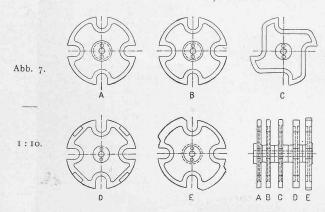
erwähnten vier Wulste zwischen die Scheiben zu liegen kommen, wenn ein Stab eingeführt oder herausgezogen wird. Die Scheibe C hat die Form eines Kreuzes und steht mit der elektromagnetischen Auslösevorrichtung in Verbindung (Abb. 8 a, b, c) und zwar in der Weise, dass bei einer Drehung von C in der Richtung des Uhrzeigers die Schulter H am Ankerhebel sich sperrend an einen Arm des Kreuzes legt (in Abb. 8 ist die "Kreuzscheibe" durch die
