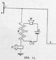
erstellt (Abb. 13). Der Schluss des primären Stromkreises erfolgt in bekannter Weise durch Druck auf den am Mikrotelephon angebrachten Taster P. Das Hörtelephon ist somit beständig an die Linie angeschlossen, sodass in Wirklichkeit ein Teil des abgehenden Stromes über 5, II, T zur Erde gelangt, ebenso teilt sich der ankommende Strom zwischen II und T einer-
