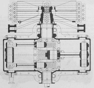
Abb. 7. Horizontalschnitt durch Kurbeltrieb, Ventilator und Kühler.
