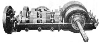
Abb. 9. Hauptkupplung, Wechselgetriebe und Differentialgetriebe.
