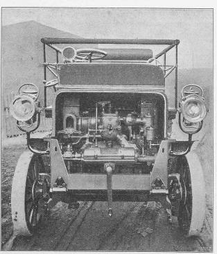
Abb. 3. Vorderansicht des «Soller»-Wagens nach Wegnahme des Motorverschalungsblechs.
