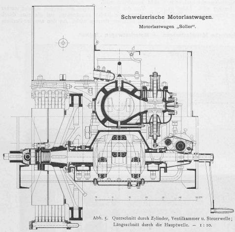
wird von dieser aus durch ein Schneckenräderpaar angetrieben. Sie trägt die Nocken zur Betätigung des Magnetapparates und dessen Abreissvorrichtung, des Einlass- und des Auslassventils; ferner treibt sie den Regulator, die Wasserpumpe und die Oelpumpe, letztere durch eine Kette, an.
