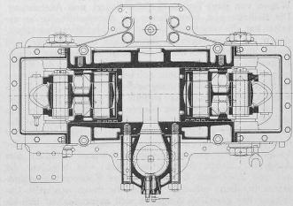
Abb. 6. Horizontalschnitt durch Zylinder und Ventilkammer. — 1:10.
