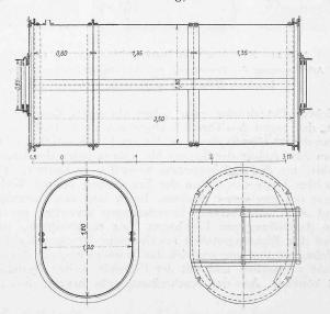
Abb. 22. Detail der Personenschleuse in Caisson 2. — 1:50.
