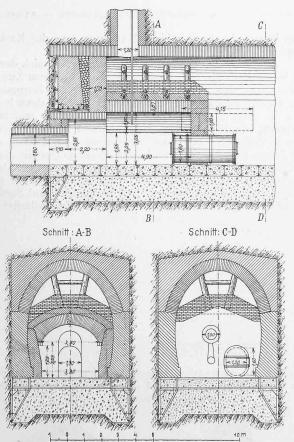
Abb. 21. Längenschnitt und Querschnitte durch die gemauerte Schleusenkammer in Caisson 2 zum horizontalen Druckluftvortrieb gegen Caisson 4. — Masstab 1:200.
