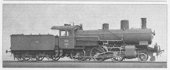
Abb. 1. Ansicht der Heissdampf-Personenzugslokomotive Serie B3/4 der S. B. B.
