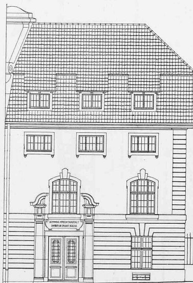
Abb. 9. Geometrische Ansicht der Fassade am Luftgässlein. — 1 : 200.
