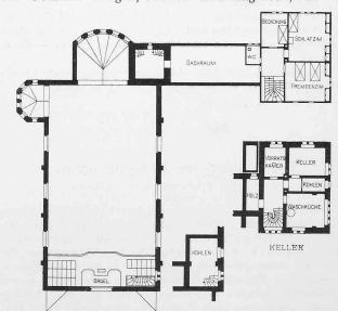
Grundrisse von der Empore sowie vom Kellergeschoss und Obergeschoss des Pfarrhauses. — Masstab I: 400.
