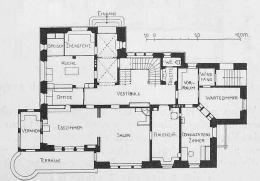
Abb. 2. Grundriss vom Erdgeschoss. — Masstab 1:400.
