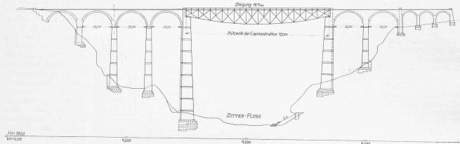
Abb. 4. Sitterviadukt. Halbparabelträger mit anschliessenden Steingewölben. — Masstab 1:2000.
