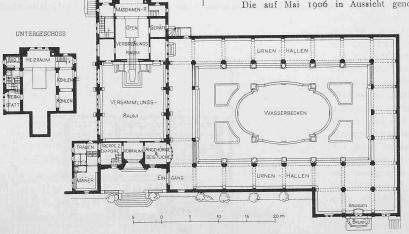
Grundrisse vom Hauptgeschoss und vom Untergeschoss. — Masstab 1:600.
