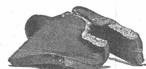
Baggermaschinen für Nass- und Trockenbaggerung. Baggerlöffel.
