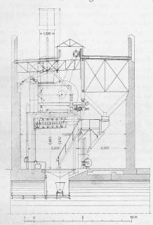
Abb. 47. Kesselhausquerschnitt. — 1:250.
