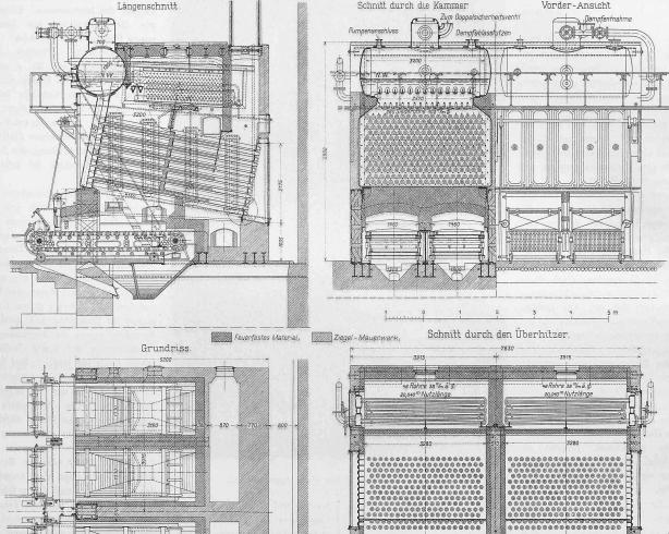
Abb. 44. Wasserröhrenkessel mit Ueberhitzer System Dürr, mit Kettenrostfeuerung. — Masstab 1:100. Gebaut von der Düsseldorf-Ratinger Röhrenkesselfabrik vormals Dürr & Cie.
