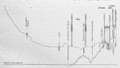
Abb. 4. Talquerprofil bei Haag. - Masstab 1:25000 f. d. L., 1:250 f. d. H.
