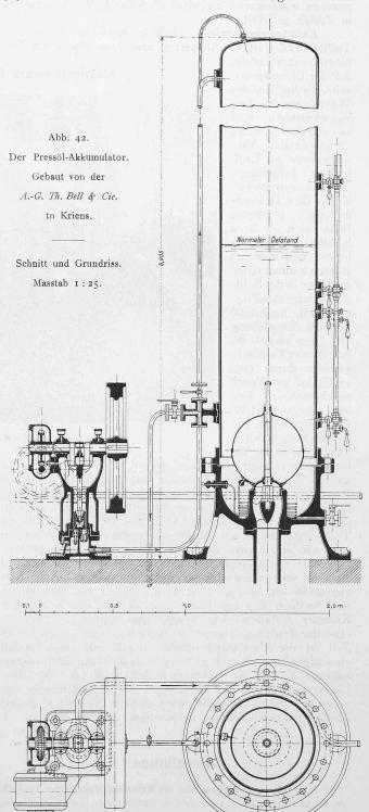
Jeder Akkumulator ist mit besonderem Luftkompressor versehen, der mittelst Elektromotor und Schneckengetriebe so oft in Gang gesetzt wird, als ein Nachspeisen des Luftkissens erforderlich ist. Ein Kompressor liefert bei 125 minutlichen Umdrehungen eine volumetrisch auf 25 Atm. gepresste Luftmenge von etwa 0,34  $m^3$  in der Stunde.
