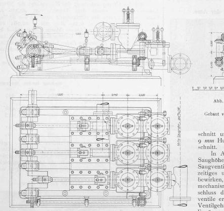
Abb. 38a. Dreizylinder-Hochdruckpumpe zur Erzeugung des Pressöles. Gebaut von Ing. A. Schmid, Maschinenfabrik in Zürich. Masstab 1:30.
