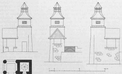
Abb. 2. Transformatorenhäuschen ausserhalb der Stadt. — Masstab 1:200.
