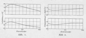
Die Zunahme des effektiven Wattverbrauches betrug im Mittel  $6,3\,^0/_0$ , bei der 25kerzigen und  $3,6\,^0/_0$  bei der 32kerzigen Lampe. (Abb. 2.)
