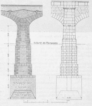
Abb. 5. Querschnitt und Ansicht eines Strompfeilers. — 1:250.
