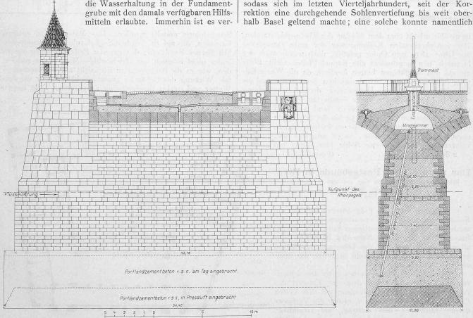
Abb. 8. Längsansicht und Querschnitt des Mittel-(Gruppen-)Pfeilers. — Masstab 1:250.
