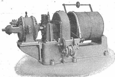
mit automatisch-elektrischer Druckknopfsteuerung
