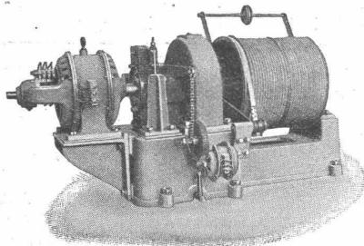
mit automatisch-elektrischer Druckknopfsteuerung
