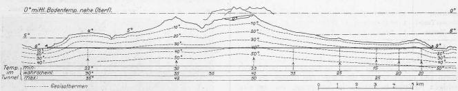
Abb. 5. Voraussichtlicher Verlauf der Kurven gleicher Temperaturen. Nach dem Gutachten von Prof. A. Heim. — Masstab 1:125000.
