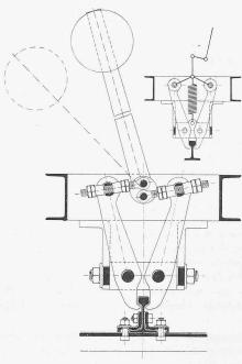
Abb. 17 u. 18. Exzenter- und Kniehebel-Zangenbremse der Schweiz. Lokomotivfabrik. \$\to\$ Patent Nr. 13679.
