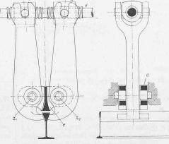
gewinde versehene, die Zangen oben auseinandertreibende Spindel k dreht, auf eine einstellbare Reibungskupplung l gesetzt, die ein zu plötzliches Anhalten des Wagens vermeiden soll. Durch das Gewicht P wird auch  $P_1$  ausgelöst und damit die zweite Zange durch einen gleichwirkenden Mechanismus in Tätigkeit gebracht. Das Gestänge m m gestattet, die Bremse von der Führerplattform aus
