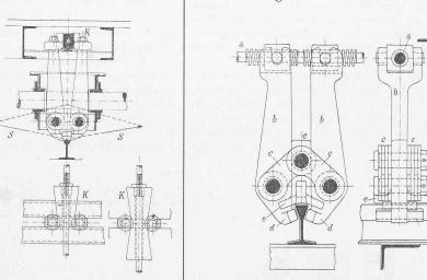
Abb. 23. Zangenbremse der Schweizer. Lokomotivfabrik.
